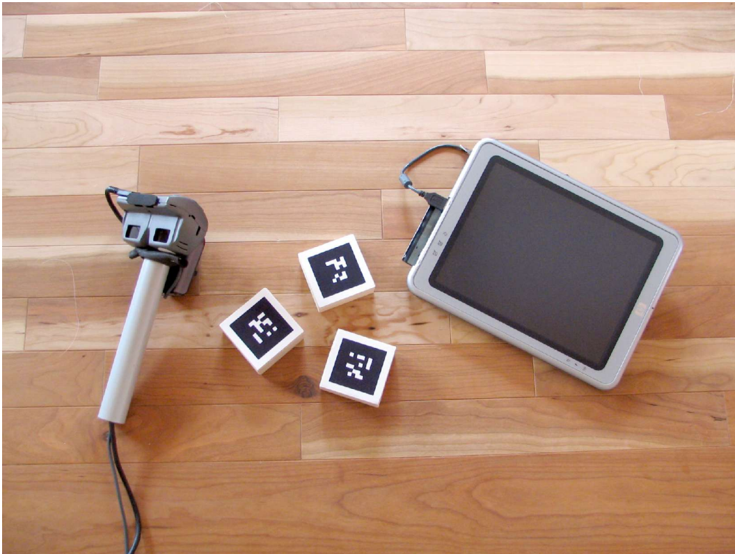
Ein umgebautes HMD, Marker und ein Tablett-PC.
